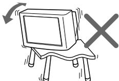
放置电视机于稳定的、并足以支撑电视机重量的电视支架及地面上。确保电视支架的表面平整且表面积大于电视机底面。
